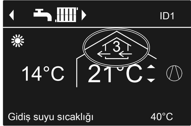
Res. 20 „ Otomatik havalandırma “ işletme programında havalandırma için örnek, işletme durumu „ Normal “
